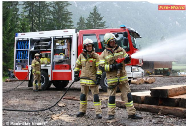
Zur Abgabe des 1000 l Wasser umfassenden Tanks kommt eine Kolbenmembranpumpe über Nebenantrieb zum Einsatz. Bei 40 bar können 250 l/min über den 80 m langen formbeständigen HD-Schlauch abgegeben werden. Die Verwendung des eingebauten Zumischers erlaubt die Beimischung von Schaummittel. Schlauchhaspel und Pumpenbedienstand finden sich im Geräteraum 4, zudem kann von hier auch der pneumatische Lichtmast mit 12 LED Scheinwerfern gesteuert werden.
